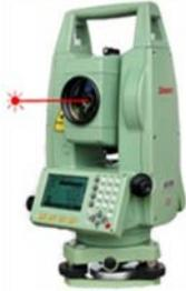
**توتال استیشن:** در سال های اخیر و با پیشرفت وسایل و تجهیزات نقشه برداری یابها و تئودولیتها با هم تلفیق شده و بصورت یک دستگاه مورد استفاده قرار می گیرد.
