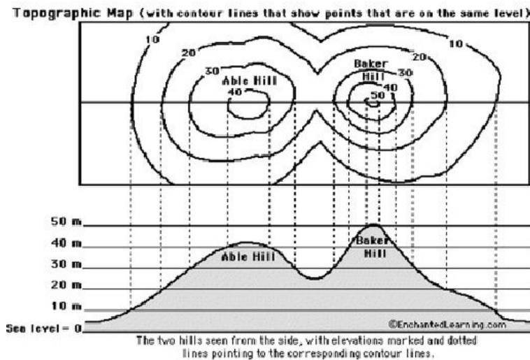
**پروفیل طولی:** نیم‌رخ طولی (پروفیل طولی) نشان‌دهنده‌ی تغییرات ارتفاعات می‌باشد، وضعیت ارتفاعی زمین در مسیر توسط پروفیل طولی مشخص می‌شود. فصل مشترک صفحه قائم گذرنده از مسیر با زمین نشان‌دهنده‌ی نیم‌رخ طولی است.
