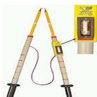
فاز متر دوبل فشار متوسط شامل دو عدد فاز متر دسته عالیق می‌باشد که به صورت دوبل و توسط یک کابل بهم مرتبط بوده و هر کدام از فاز مترها در یک دست سیمبان قرار می‌گیرد. سپس با اتصال شاخصهای سر آن به فازهای مختلف دو طرف، اگر لامپی که در وسط فاز متر تعییه شده روشن شود، این بیانگر غیر همنام بودن فازها می‌باشد و اگر لامپ روشن نشود، به معنی هم‌فاز بودن فاز مورد نظر می‌باشد و ارتباط جمپر آن بلامانع می‌باشد.
